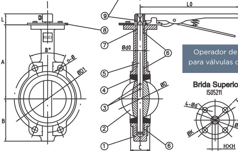
Operador de Palanca para válvulas de 2" a 12"
