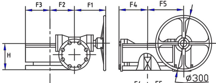
Tipo de Operador de Engranés para válvulas de 16" a 24"
