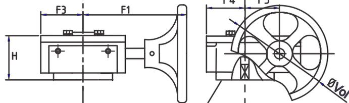
Tipo de Operador de Engranés para válvulas de 2" a 14"
